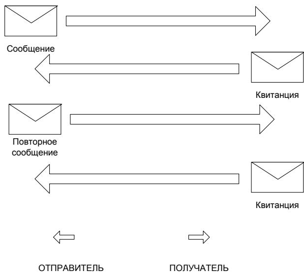
Алгоритм работы отправителя и получателя приведен ниже:
